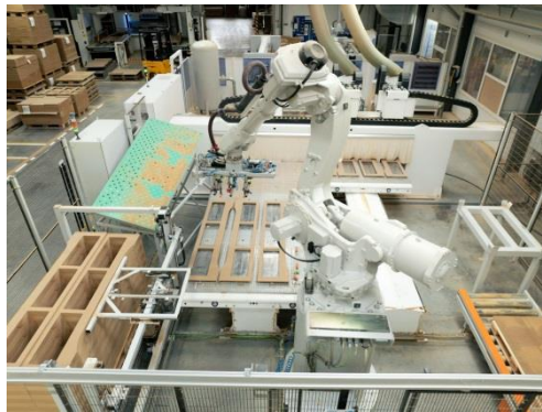
Роботизоване збирання та обробка складних дерев'яних конструкцій. Джерело: Halfpoint / Getty Images
