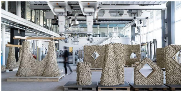
Просторова роботизована фабрикація органічних форм з біоматеріалів.
