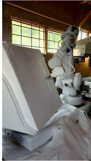
Роботизоване фрезерування матриць для параметричних елементів. Джерело: ENCY Software
